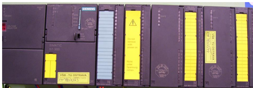
Obr. 13.18 – Výsledná fyzická konfigurace PLC s bezpečnostními prvky..
