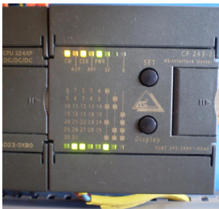
Obr. 2.6 Příklad zapojeného slavu číslo 1 a 2 určeného podle svítících LED diod sloupce a skupiny.
