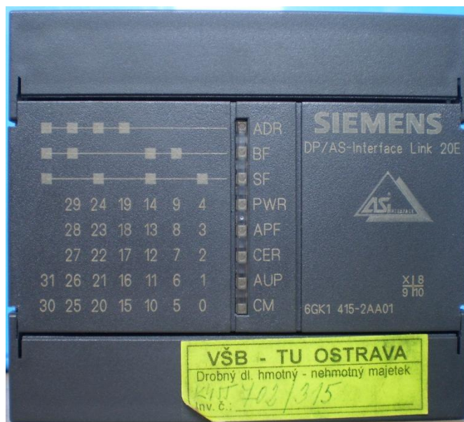
Obr. 3.6 Náhled na čelní panel DP/AS-i linku.
